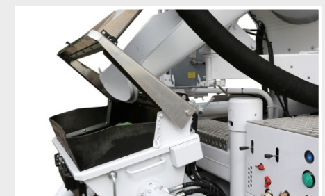
Trichterabdeckung in Stellung „Eigene + externe Befüllung“
