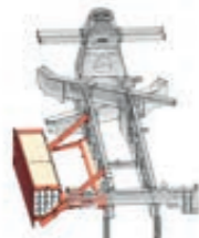
Ladebox, hydraulisch absenkbar, 3,00 m - mit 13 x 125er Hülsen - oder 8 x 160er Hülsen - mit aufgesetzter Ladefläche - kombinierbar mit Ladewannen
