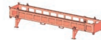
Ladebox, 3,10 m / 4,10 m / 5,10 m - abnehmbar - Ladebox 4,10 m optional mit Hülsen
